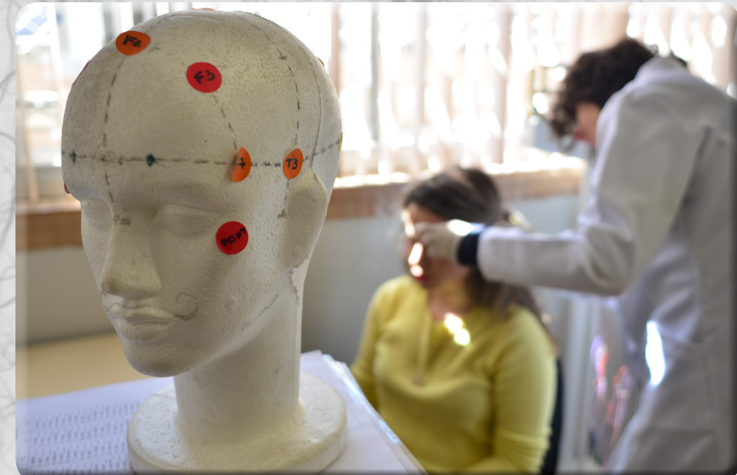
Para o experimento, são colocados eletrodos na cabeça em pontos específicos, conforme o modelo.
